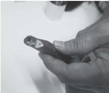
金属3D積層造形機で製作したボーリングパイプ
